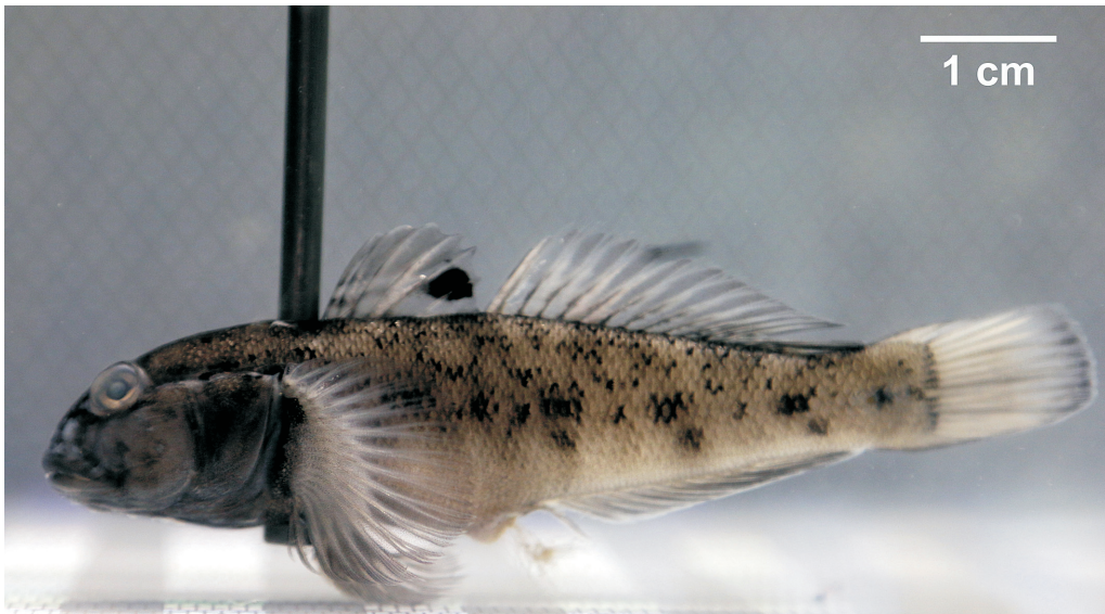
Abb. 3 In einem Laborversuch der Universität Basel werden bereits tote Schwarzmundgrundeln an einem Stab im Strömungskanal fixiert. So werden die Kräfte bestimmt, die der Fisch bei der Passage eines Fischpasses überwinden muss. So soll ein Mittel gefunden werden, um den Aufstieg der Fische zu regulieren.
